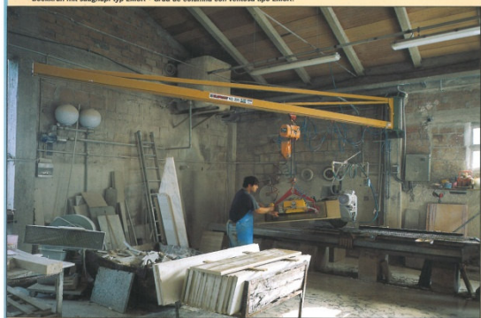
GRU A PARETE CON VENTOSA TIPO LM1R • Wall crane with LM1R vacuum grab • Grue murale avec ventouse type LM1R • Wandkran mit saugnapf typ LM1R • Grúa de pared con ventosa tipo LM1R.
