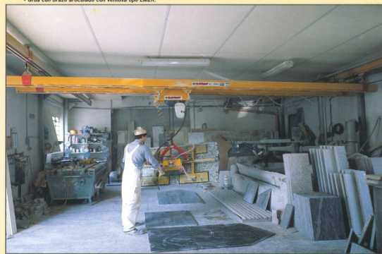
IMPIANTO SOSPESO BITRABE CON VENTOSA TIPO LM4R • Suspended double-beam unit with LM4R vacuum grab • Installation suspendue à deux poutres avec ventouse type LM4R • Zweiträger-hängeanlage mit saugnapf typ LM4R • Dispositivo suspendido con dos largueros con ventosa tipo LM4R.
