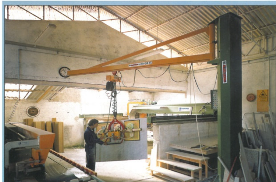
GRU A COLONNA CON VENTOSA TIPO LM3R • Column crane with LM3R vacuum grab • Grue a colonne avec ventouse type LM3R • Bockkran mit saugnapf typ LM3R • Grúa de columna con ventosa tipo LM3R.
